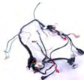
Cross 50 glavna instalacija 050402220004
